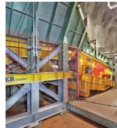
Vorbrechanlage, Fluss- und Feldspat, 80t/h, HAVER F-CLASS, HAVER Schubwagen, Backenbrecher
