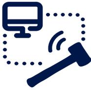
Durch den s.g. Hammerschlagtest kann die Eigenfrequenz der Maschine ermittelt werden. Das Betreiben der Maschine in der Eigenfrequenz kann zu Leistungsminderung, Schäden und Sicherheitsrisiken führen.
