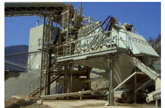
Wasch- und Klassieranlage, Kalkstein, 140t/h, HAVER HYDRO-CLEAN, HAVER L-CLASS
