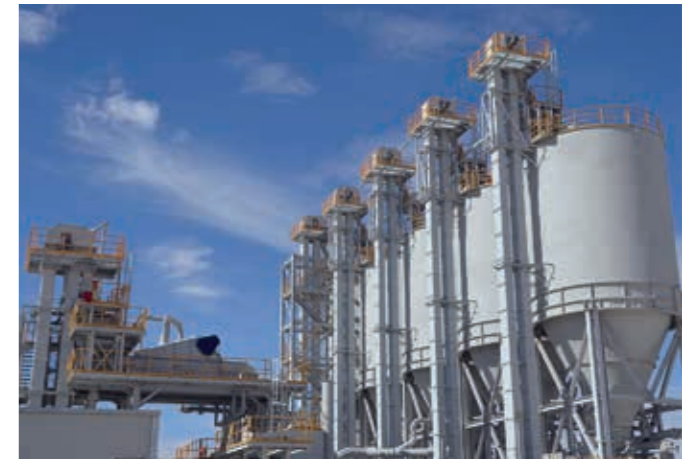
Anlage zur Feinkornklassierung, Quarzsand, 300t/h, HAYER FINE-LINE, HAYER L-CLASS
