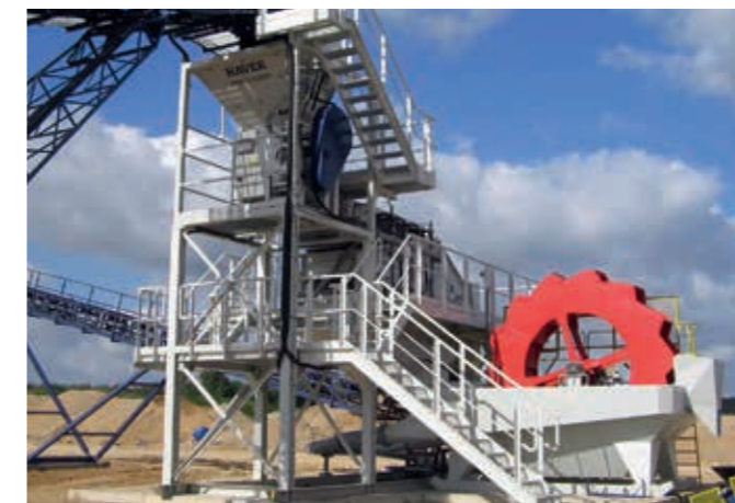
Wasch- und Klassieranlage, Natursand, 70t/h, HAVER HYDRO-CLEAN, HAVER L-CLASS, HAVER Schöpfrad
