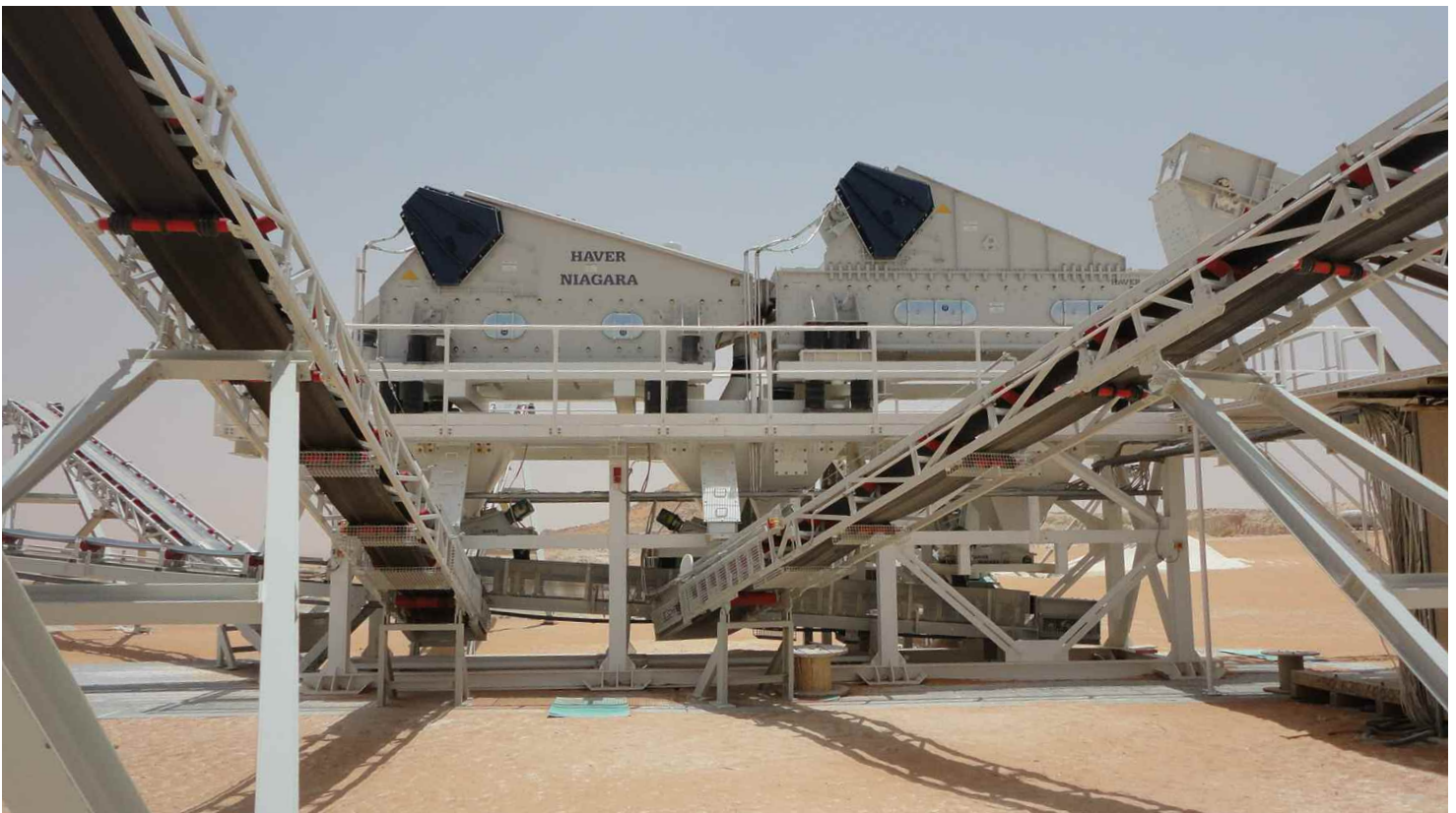
Nacheinander geschaltete L-CLASS; Kombination Positiv- und Negativsiebung
